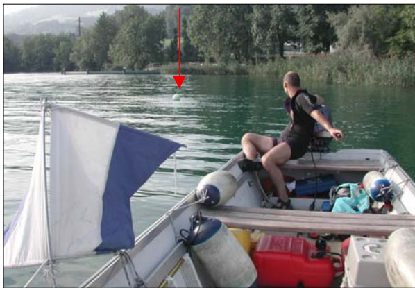
Begleitung des Tauchers mit dem Boot. Die Position des Tauchers ist mit der Boje ersichtlich (Pfeil). Die Taucharbeiten werden mit einer blau-weissen Fahne angezeigt.
