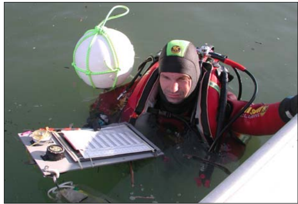
Taucher nach Abschwimmen eines Tauch-Transektes mit Positions- und Rettungsboje, Protokolltablett mit Erfassungsblatt, Tiefenmesser, Kompass sowie Netz für die Entnahme von Pflanzenproben.
